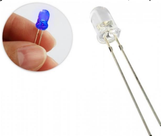
Imagem 33 – LED de auto brilho azul, do tipo automático
